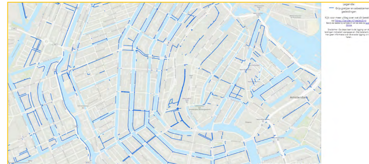
Figuur 10. Opgave brosse gasleidingen Amsterdam binnenstad (Bron: Gemeente Amsterdam: Data en informatie (amsterdam.nl))
